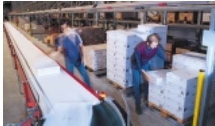
Kommissionierung Pick by light auf das Sorter-Zuführband
